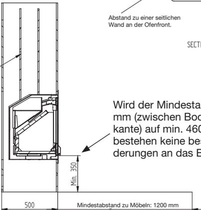
Wird der Mindestabstand min. 350 mm (zwischen Boden und Türunterkante) auf min. 460 mm vergrößert, bestehen keine besonderen Anforderungen an das Bodenmaterial.
