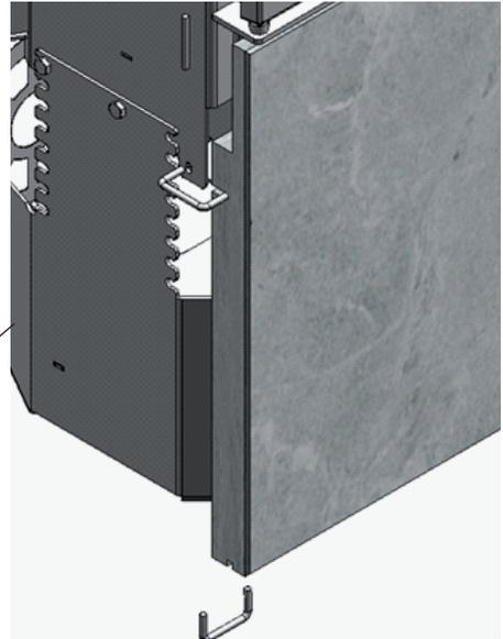
Man fängt mit dem untersten Frontstein an. Zunächst zwei Bügel unten und einen Bügel auf jeder Seite des Specksteins oben einsetzen, die in die ovalen Löcher in der Ofenseite eingehakt werden. Siehe Fig. 2.
