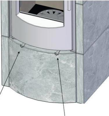
Hebel für die sekundäre Luftzufuhr.
