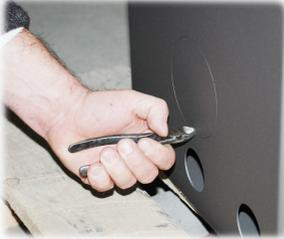
Mit einem Seitenschneider das Metallstück abschneiden, das die kreisförmige Abdeckung an der rückwärtigen Platte hält. Diese ist herauszudrehen
