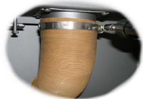
Danach das Rohr mit einer Schlauchlemme befestigen.
