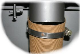
Es ist auf den Stützen (Ø 100 mm) zu schieben, der sich hinter dem Aschenkasten befindet.
