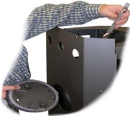
Abb. 11 Kappe von der hinteren Öffnung abnehmen und den Halter (soweit vorhanden) durch die obere Öffnung herausnehmen.
