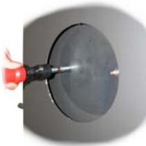
Abb. 10 Die beiden Schrauben lösen, mit denen die Kappe am Ofen befestigt ist.
