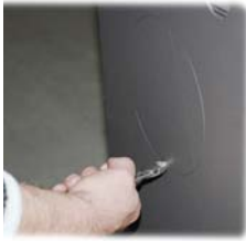
Abb. 9 Mit einem Seitenschneider das Metallstück abschneiden, das die kreisförmige Abdeckung an der rückwärtigen Platte hält. Dann die Abdeckung herausziehen.
